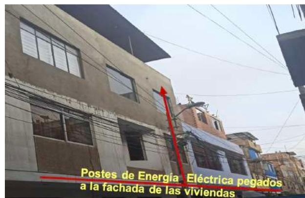
**FOTO N.º 23. A.H. LOS OLIVOS DE PRO, POSTES DE ENERGÍA ELÉCTRICA, PEGADOS A LA FACHADA DE LAS VIVIENDAS.**
