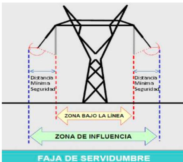
Ancho mínimo de la faja de servidumbre de electroducto, según nivel de tensión (voltaje):
