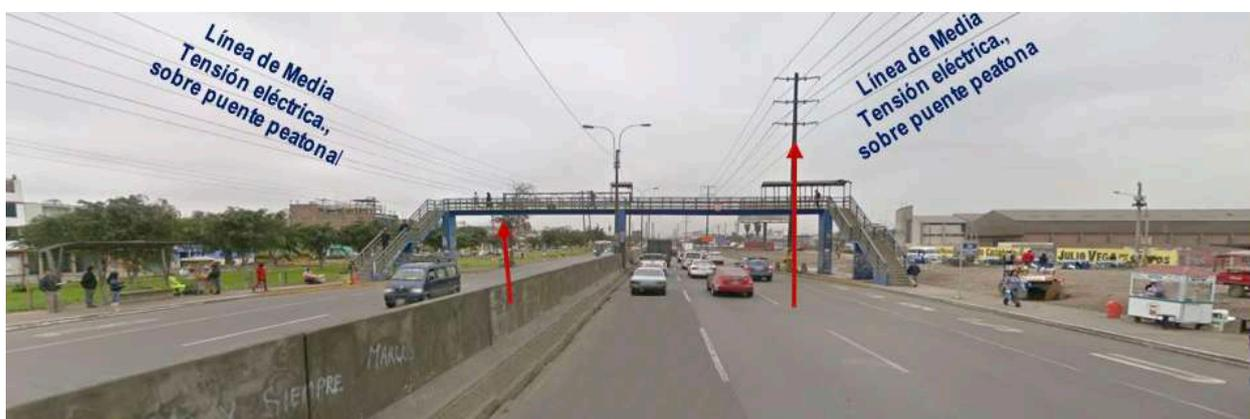
**FOTO N.º 26. Av. PANAMERICANA NORTE, PUENTE PEATONAL VIPOL, ALTURA JR. CHAQUISTAMBO, EL CRUCE PEATONAL SE ENCUENTRA CON PROTECCIÓN METÁLICA, ANTE LAS LÍNEAS DE MEDIA TENSIÓN ELÉCTRICA DE 60 KV DE LAS LÍNEAS: L.T. CHAVARRÍA-PUENTE PIEDRA (L-636), L.T. CHAVARRÍA-CAUDIVILLA (L-625), L.T. CHAVARRÍA-NARANJAL (L-698), L.T. CHAVARRÍA-INFANTAS (L-697).**
